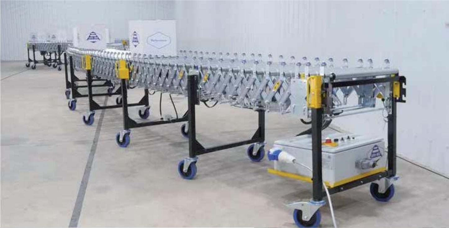
**Master & Slave Förderer** ermöglichen es dem Anwender schnell und einfach zwei Förderer zu einer langen Förderstrecke zu verbinden. Wenn die Förderer nicht miteinander verbunden sind, können sie eigenständig genutzt werden.
